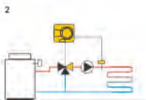
Control de la temperatura de suministro.
