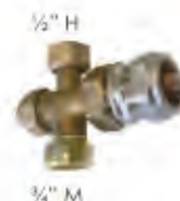
Cuerpo cruz CW617N; Tubo portavaina: compresión 18mm; Salida auxiliar purgador 1/4"; Tornillo fijador sonda
